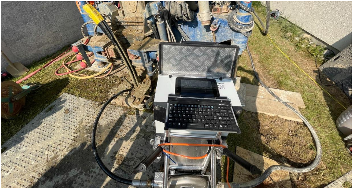
Abb. 2: Bedienung des H-EP über das eingebaute Touchdisplay und die wasserfeste Tastatur. Kontrolle der Messung. Display und Tastatur sind wasserfest und werden von einem schlagfesten Aluminium- Deckel geschützt
