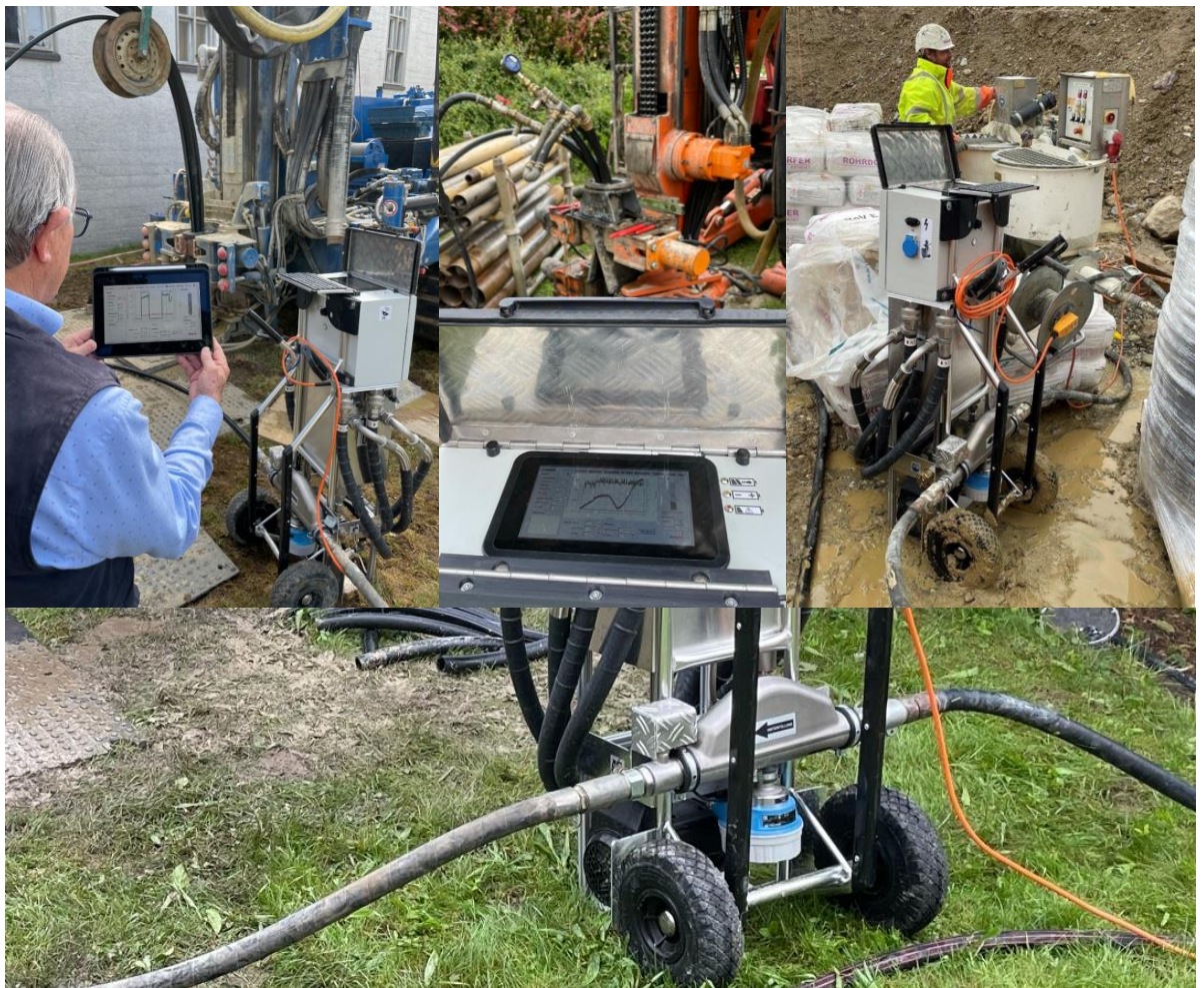
Abb. 6: Als externe Anzeige z.B. beim Mischer kann ein internetfähiges Gerät verwendet werden, wie z.B. ein wasserdichtes Smartphone. Das H-EP kann direkt beim Mischer oder bei der Sonde aufgestellt werden. Mit den passenden Verbindungsstücken lassen sich alle gängigen Schläuche an das Hinterfüllungsmessgerät anschliessen.
